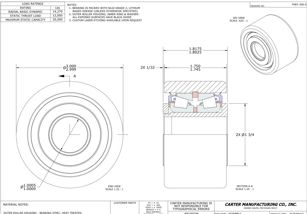
OUTER ROLLER HOUSING - BEARING STEEL, HEAT TREATED
