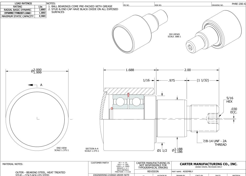
STUD - COLD ROLLED STEEL BEARING ASSM.- 6203.2RS QTY [2] SNAP RINGS - SPRING STEEL END CAP - COLD ROLLED STEEL
