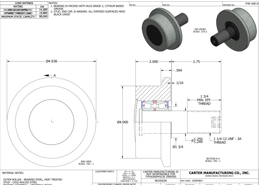
OUTER ROLLER - BEARING STEEL, HEAT TREATED STUD - COLD ROLLED STEEL BEARING ASSEMBLY - LM67000LA-902A2 WASHER - COLD ROLLED STEEL END CAP - COLD ROLLED STEEL
