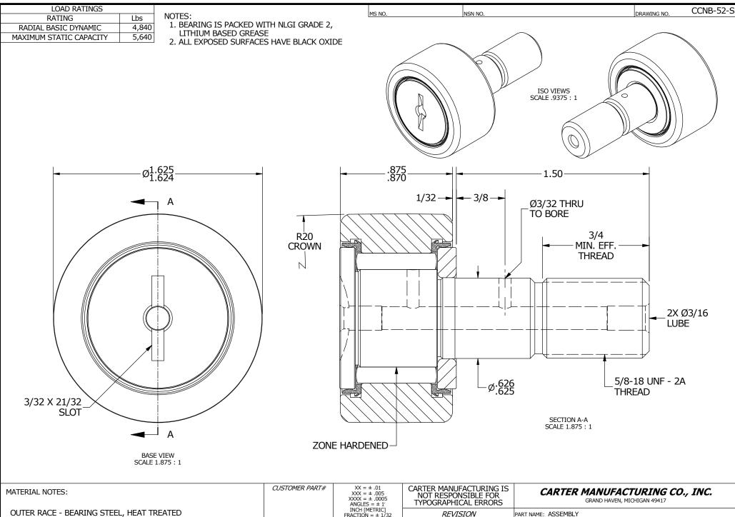
STUD - BEARING STEEL, ZONE HARDENED NEEDLE ROLLERS - BEARING STEEL, HEAT TREATED WASHER - COLD ROLLED STEEL, HEAT TREATED
